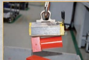
Gefährlicher Umgang mit Lasthebemagneten
